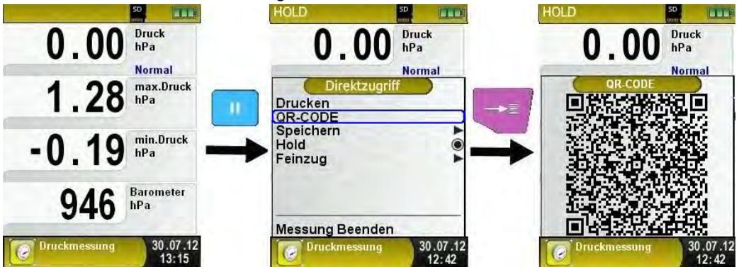
Bild 9: QR-Code Generierung, Bsp.: Druckmessung
