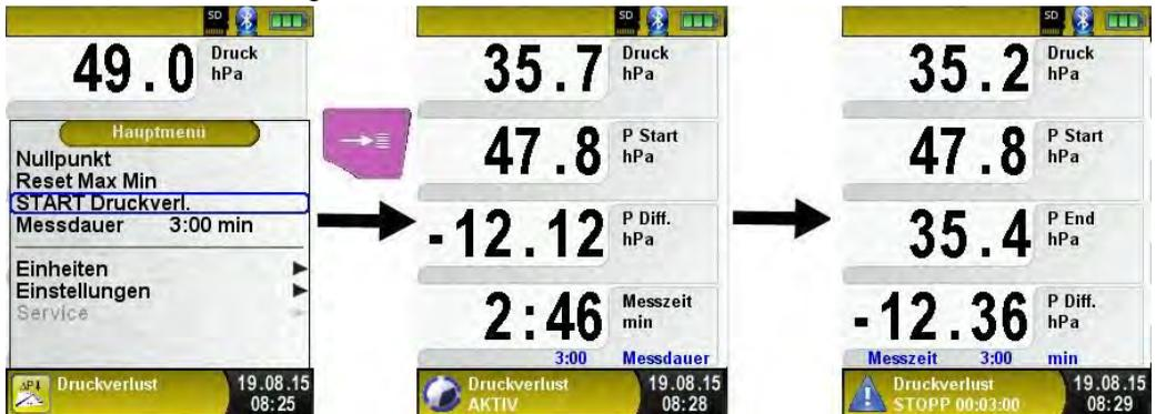
Nach erfolgter Druckverlustmessung ertönt ein Signal und in der Informationszeile wird zugleich die Meldung „Druckverlust STOPP“ mit der vergangene Messzeit angezeigt. Die Messwerte werden in der Hauptanzeige festgehalten und man kann das Messprotokoll speichern oder ausdrucken.
