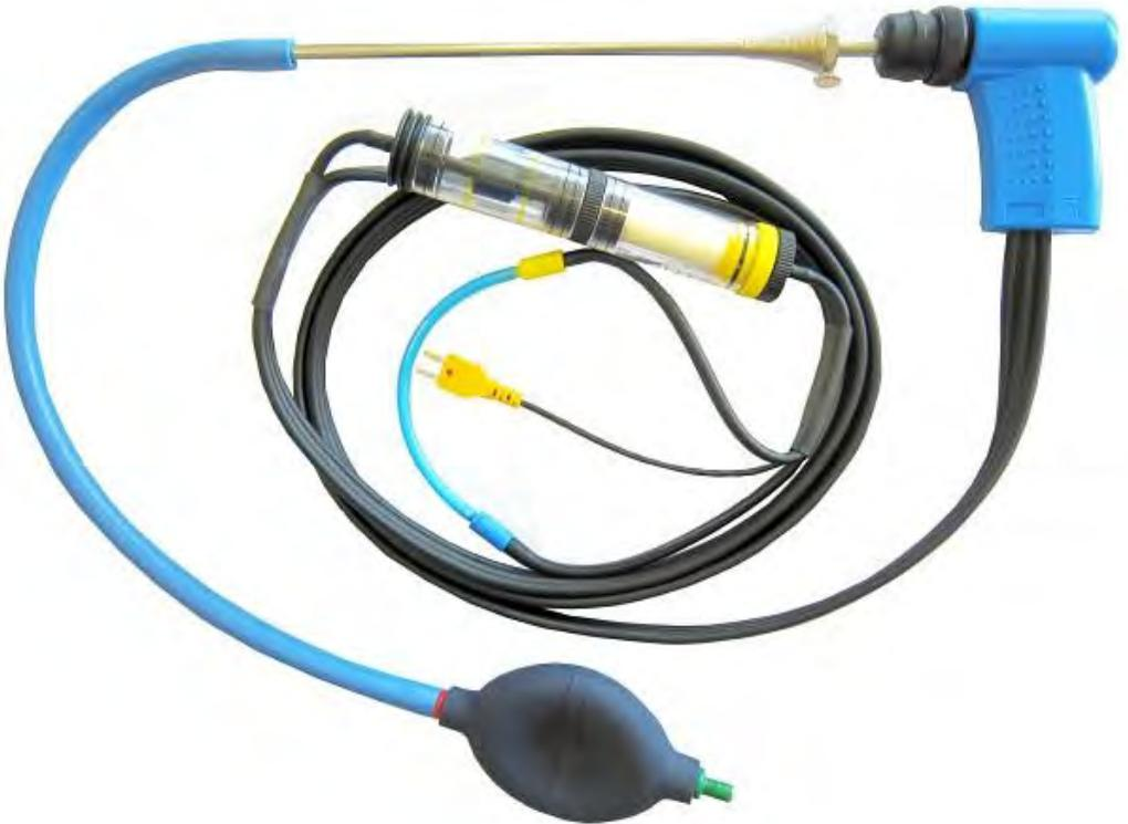
Bild 4: Aufbau der Dichtigkeitsprüfung mit dem Sondendichtheitsprüfung-Set (Art.-Nr.: 511017)
