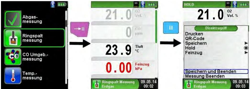
Dies kann mit allen verfügbaren Programmen wiederholt werden. In diesem Beispiel sind die Messdaten aus der Abgasmessung und der Ringspaltmessung zusammengeführt. Nun können über die „HOLD“ Taste die Messdaten gedruckt, gespeichert oder als QR-Code ange-
